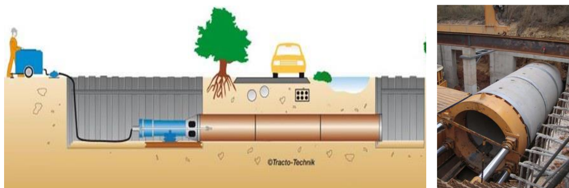
Ejemplo y esquema de pozo de ataque. Hincada por percusión
