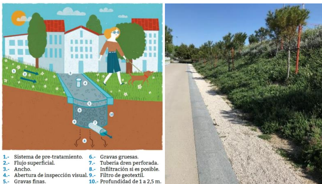
Figura: Solución de Drenaje mediante drenes filtrantes.
