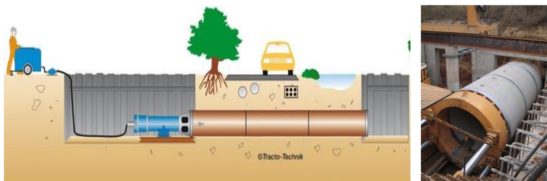
Ejemplo y esquema de pozo de ataque. Hincas por percusión
