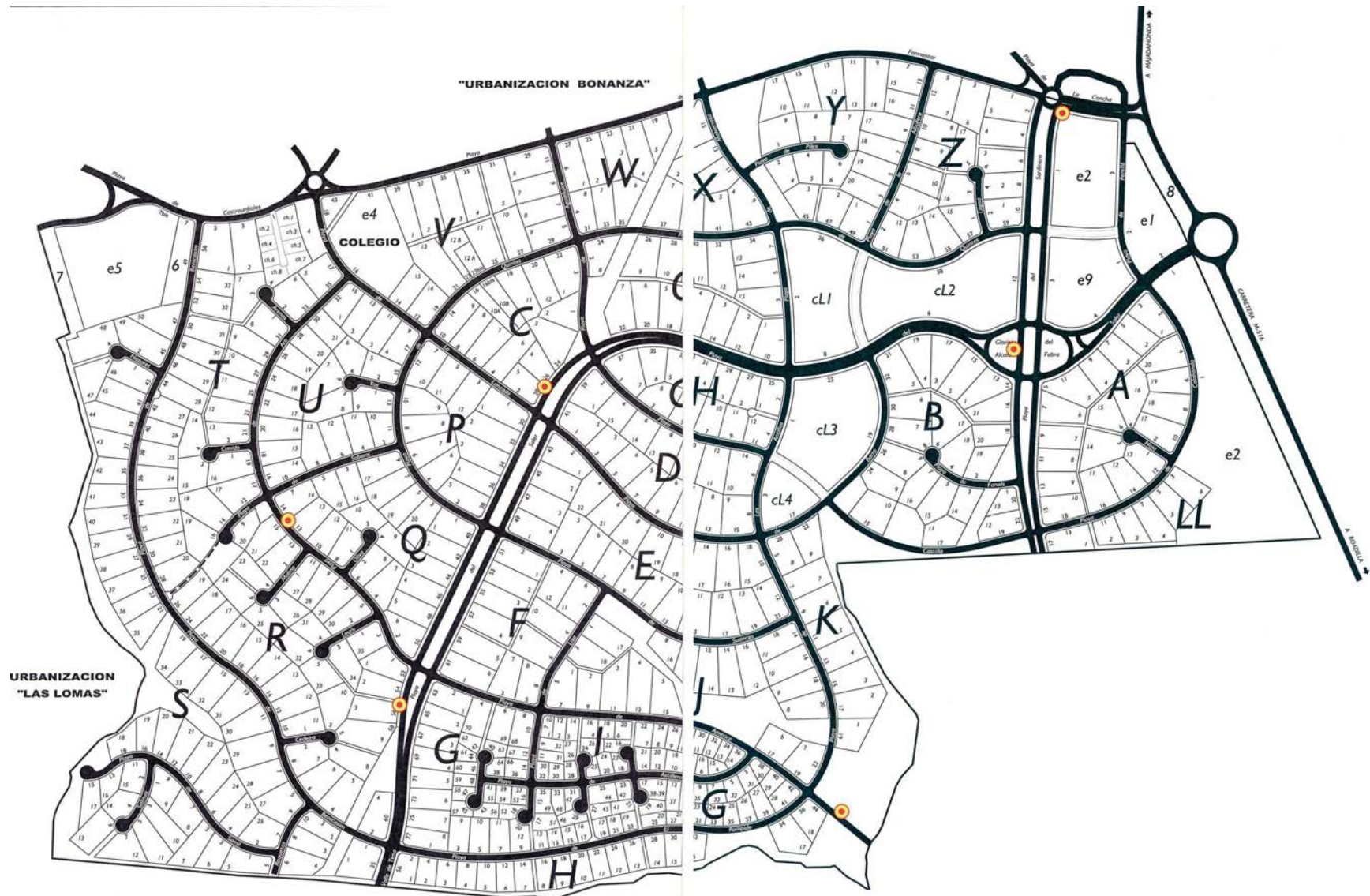
URBANIZACIÓN VALDECABAÑAS LOCALIZACIÓN DE HIDRANTES
